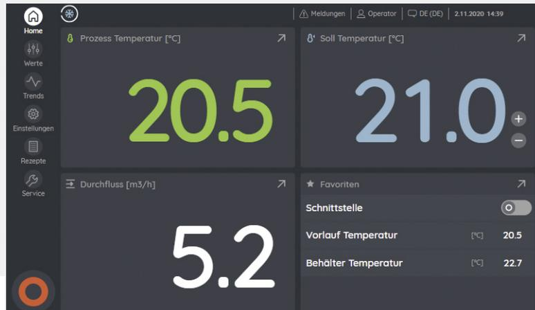
› Hochflexibles Bedienkonzept (Human-Machine-Interface) ermöglicht den Einsatz für unterschiedliche Einsatzbereiche und Monitorgrößen.
