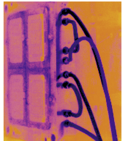
› Homogene Temperaturverteilung im Spritzgießwerkzeug nach der Reinigung der Temperierkreisläufe.
