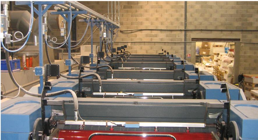
**1 | Speziell für die Farbniveauüberwachung entwickelter Ultraschall-Doppelwandlersensor mit integriertem Neigungsschalter, LED Anzeigen sowie Analog- oder Schaltausgängen**
